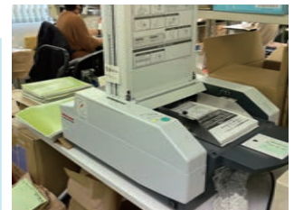
紙折り機 これ1台で二つ折り、観音折、三つ折りなどが出来ます。すごいスピードで枚数をこなします。
